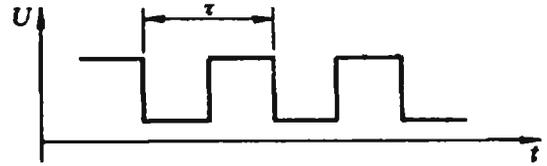
Рис. 2. Импульсы тактового генератора. Период — или такт — в микропроцессорах составляет обычно 0,1—0,5 микросекунды.
