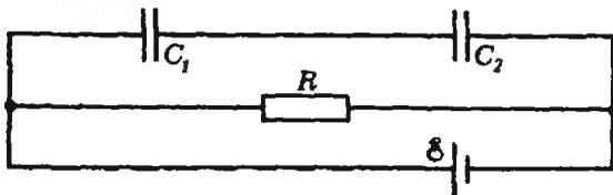
7. Найдите напряжения на конденсаторах емкостью  $C_1$  и  $C_2$  в приведенной на рисунке схеме, если известно, что при замыкании резистора сопротивлением  $R$  накоротко ток через батарею возрастает в  $n = 3$  раза. ЭДС батареи равна  $\mathcal{E}$ .
