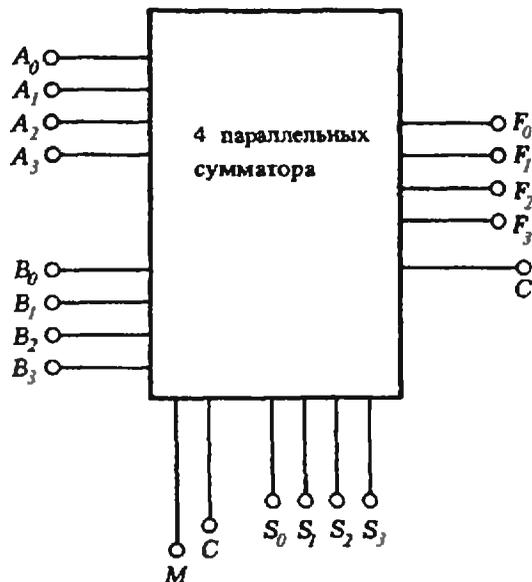
Рис. 1. Схематическое изображение связей четырехразрядного АЛУ.  $C$  — указатель сигнала сдвига и переноса разрядов.  $M$  — переключатель «арифметика — логика».
