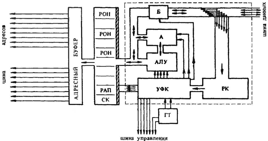
Рис. 3. Схема простейшего микропроцессора. Розовой плашкой выделена основная часть схемы, с которой мы начинали «строительство».
